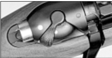
1) Gesichert, Kammer gesperrt
